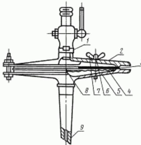
1 — кран; 2 — верхний диск; 3 — стерилизующая пластина; 4 — сетка; 5 — нижний диск;
