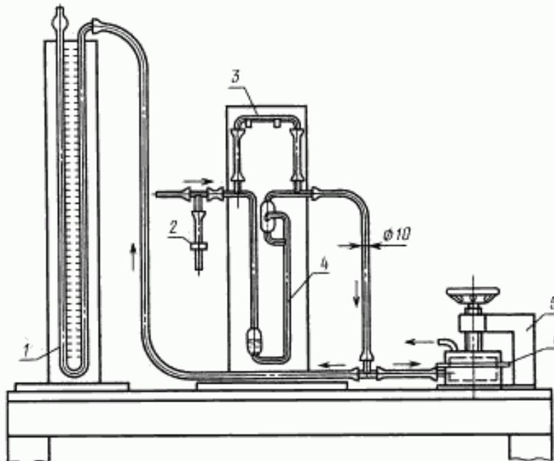
1 — U-образный манометр по НД; 2 — регулировочный винт; 3 — диафрагма (капилляр) реометра,
