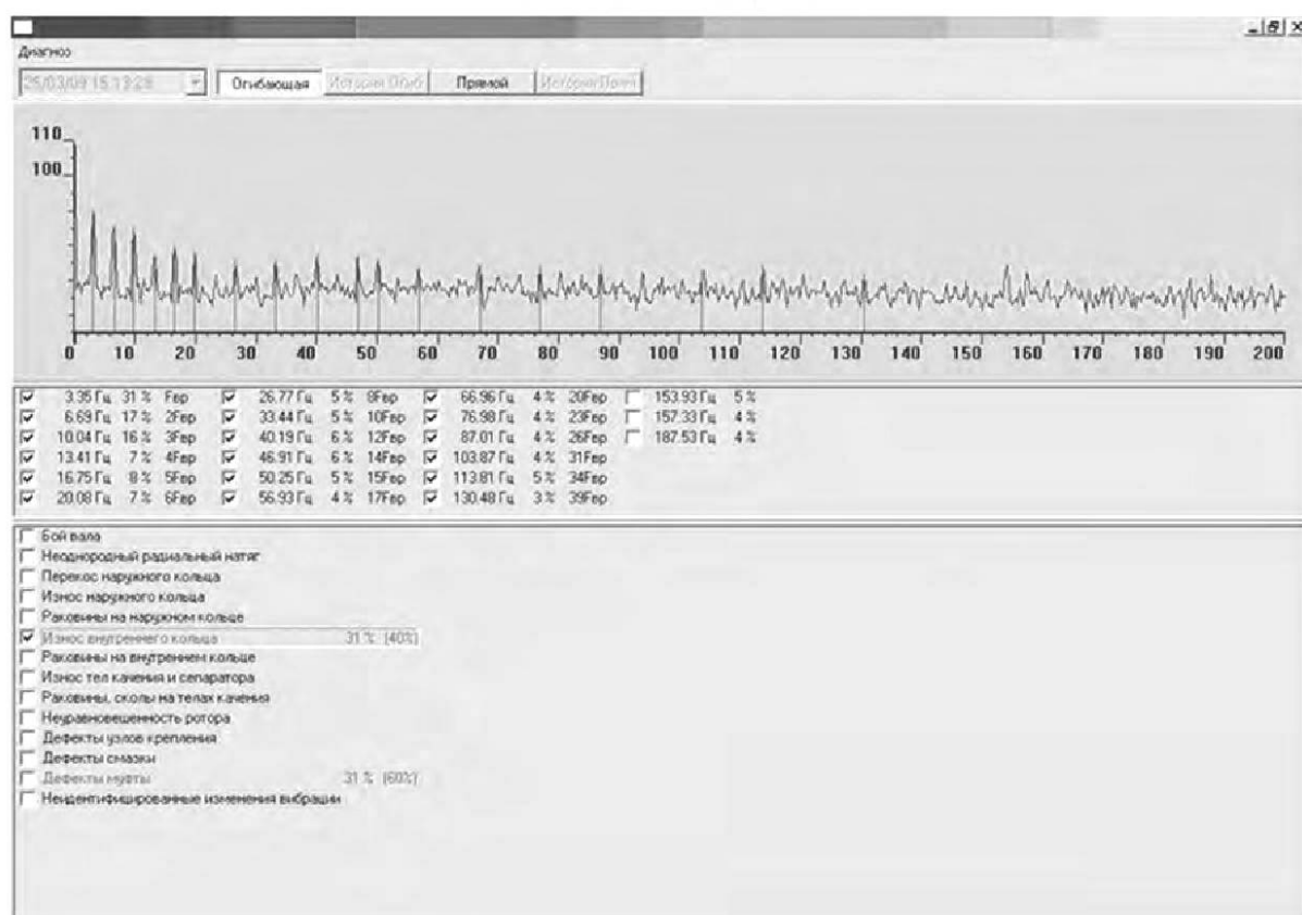
Рисунок Д.10 — График спектра огибающей станка модели 2В622Ф4
