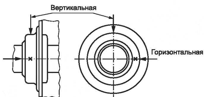
Рисунок В.2 — Точки измерения на корпусе подшипника
