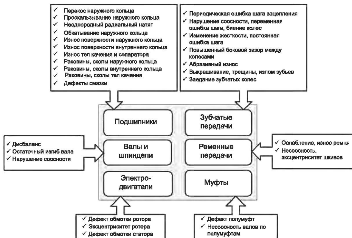
Рисунок 4 — Объекты виброакустической диагностики
