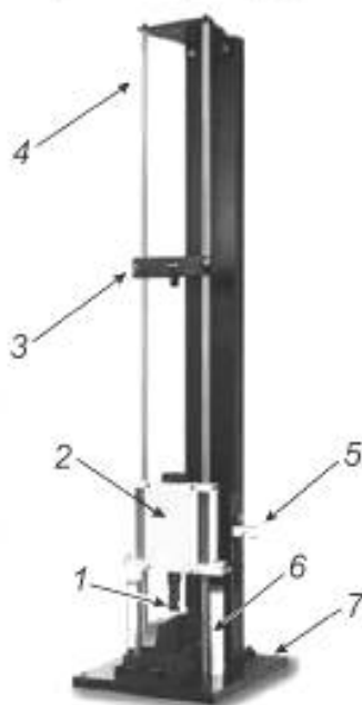
1 — индентор; 2 — траверса; 3 — фиксирующее устройство; 4 — направляющая колонна; 5 — датчик скорости перемещения индентора; 6 — блок остановки (ограничитель хода); 7 — опорная плита
