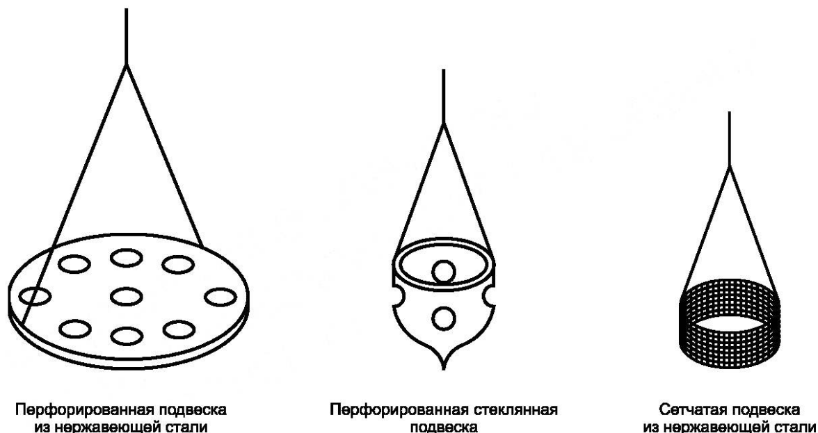
Рисунок 1 — Примеры подставок под испытуемый образец
