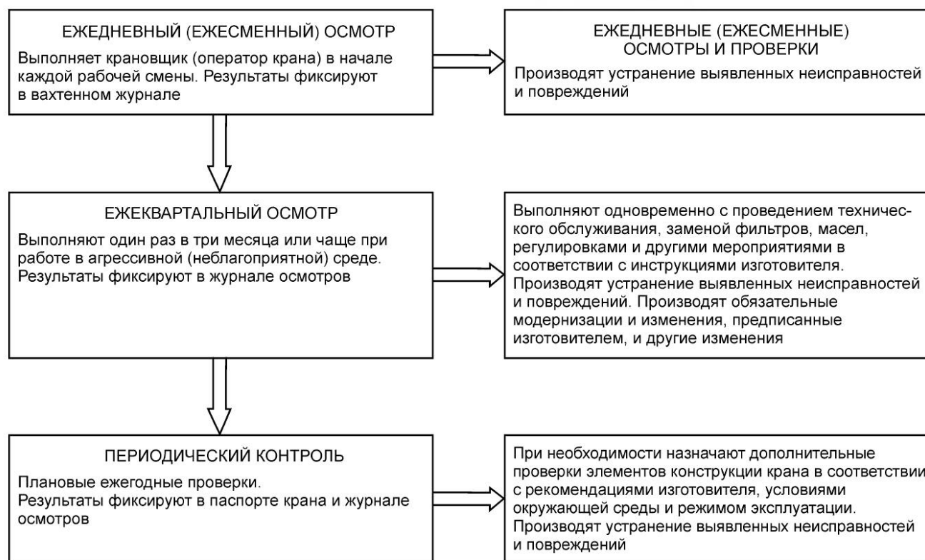
Рисунок Б.1 — Проведение технического контроля при наличии инструкций изготовителя
