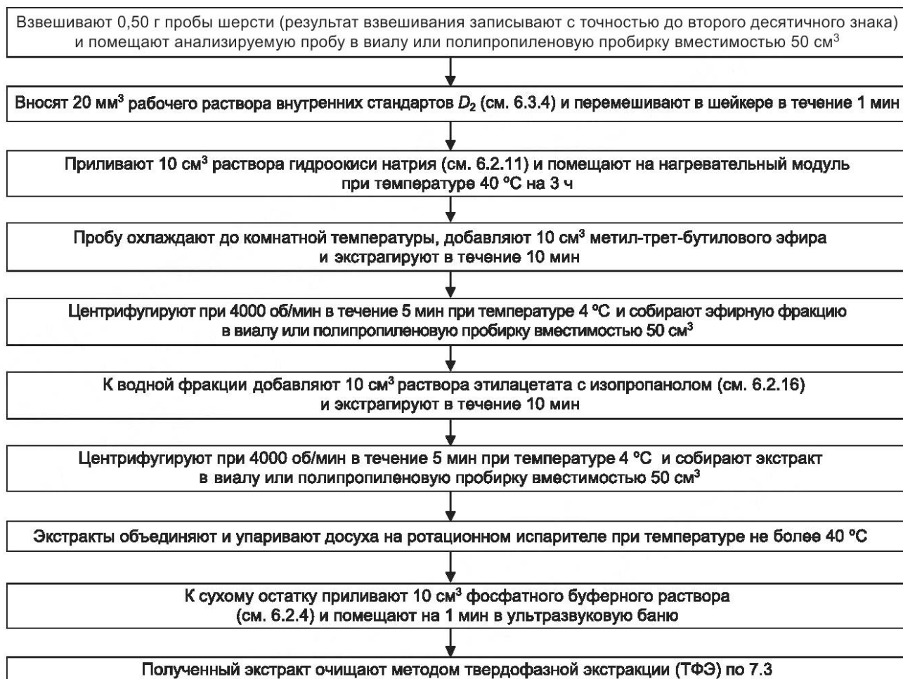
Рисунок 7 — Подготовка проб шерсти животных с использованием щелочного гидролиза
