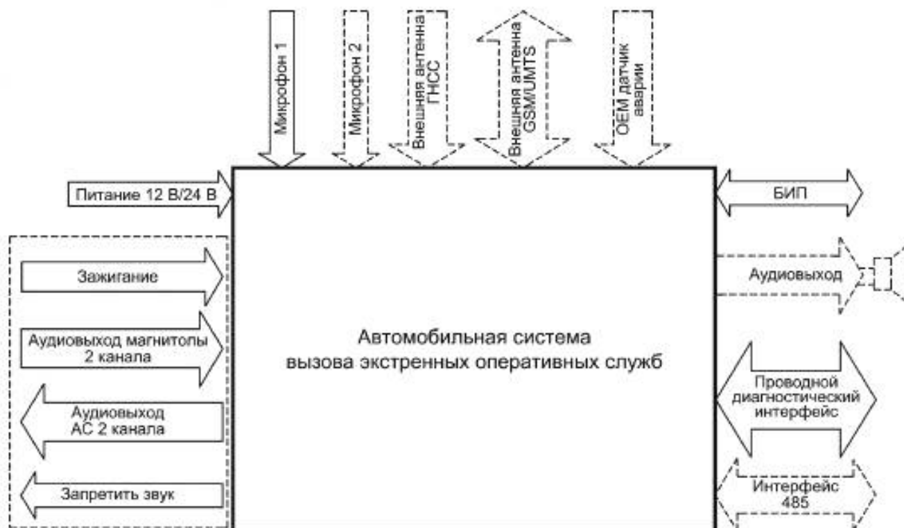
Рисунок Г.1— Пример подключения УСВ к аудиосистеме транспортного средства
