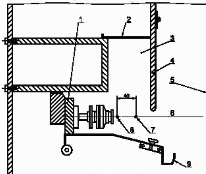
1 — панель прокуривания; 2 — разделительная перегородка; 3 — внутренний канал; 4 — передняя поворотная заслонка; 5 — передняя часть курительной машины; 6 — положение оси сигареты; 7 — стандартное положение для измерения скорости воздуха; 8 — положение устройства окончания курения; 9 — пепельница
