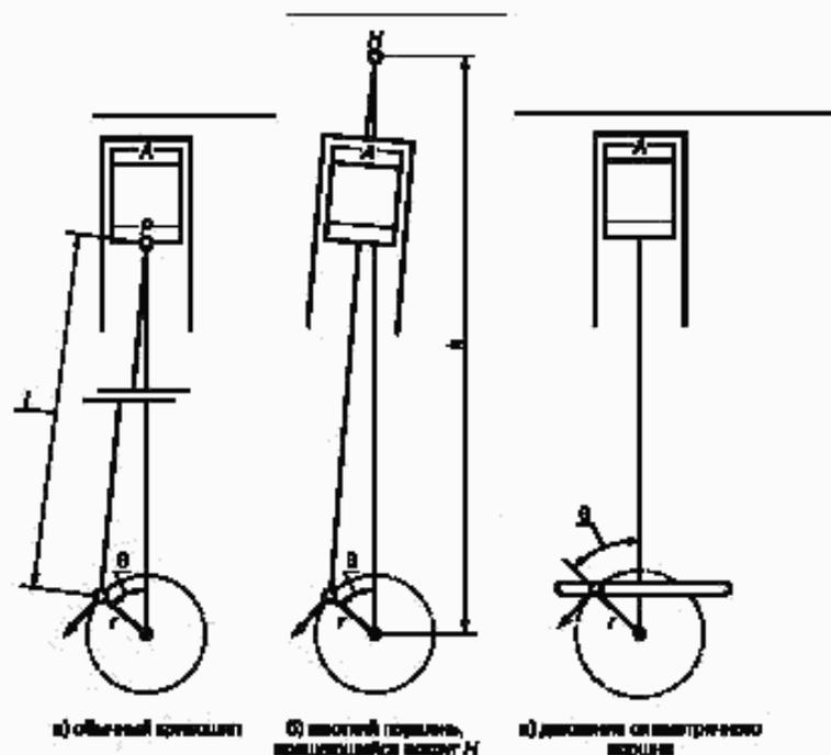
$H, p$  — центры вращения;  $A$  — площадь сечения;  $l$  — длина рычага тяги кривошипа;  $h$  — расстояние между кривошипом и центром вращения  $H$ ;  $r$  — радиус кривошипа;  $\theta$  — угловое перемещение кривошипа
