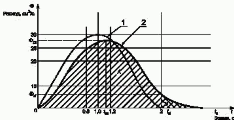
1 — профиль перемещения; 2 — профиль затяжки
