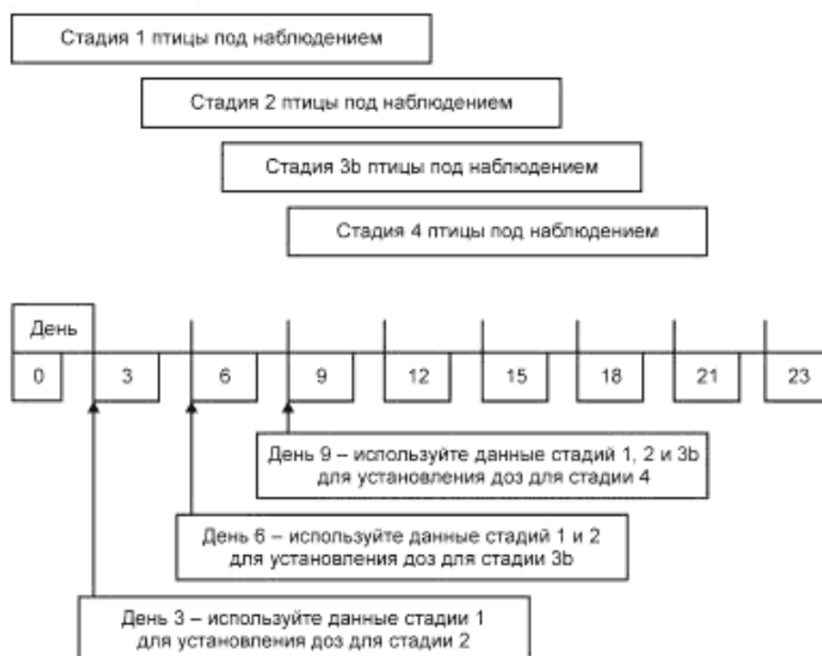
Рисунок 3 — Пример плана-графика последовательной схемы испытания с четырьмя этапами (стадии 1, 2, 3b и 4) по 14 дней, рисунок не включает контрольную группу птиц
