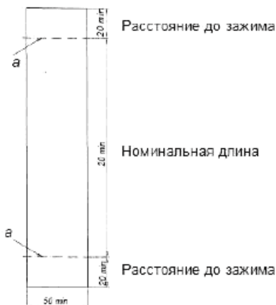
Рисунок К.1 – Детали образца для испытания
