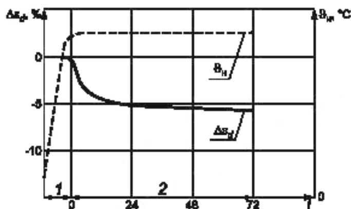
t — период нагревания; 2 — период испытания; \Delta d — изменение толщины, %; \theta_n — температура нагревательной пластины, °C; t — время, ч
