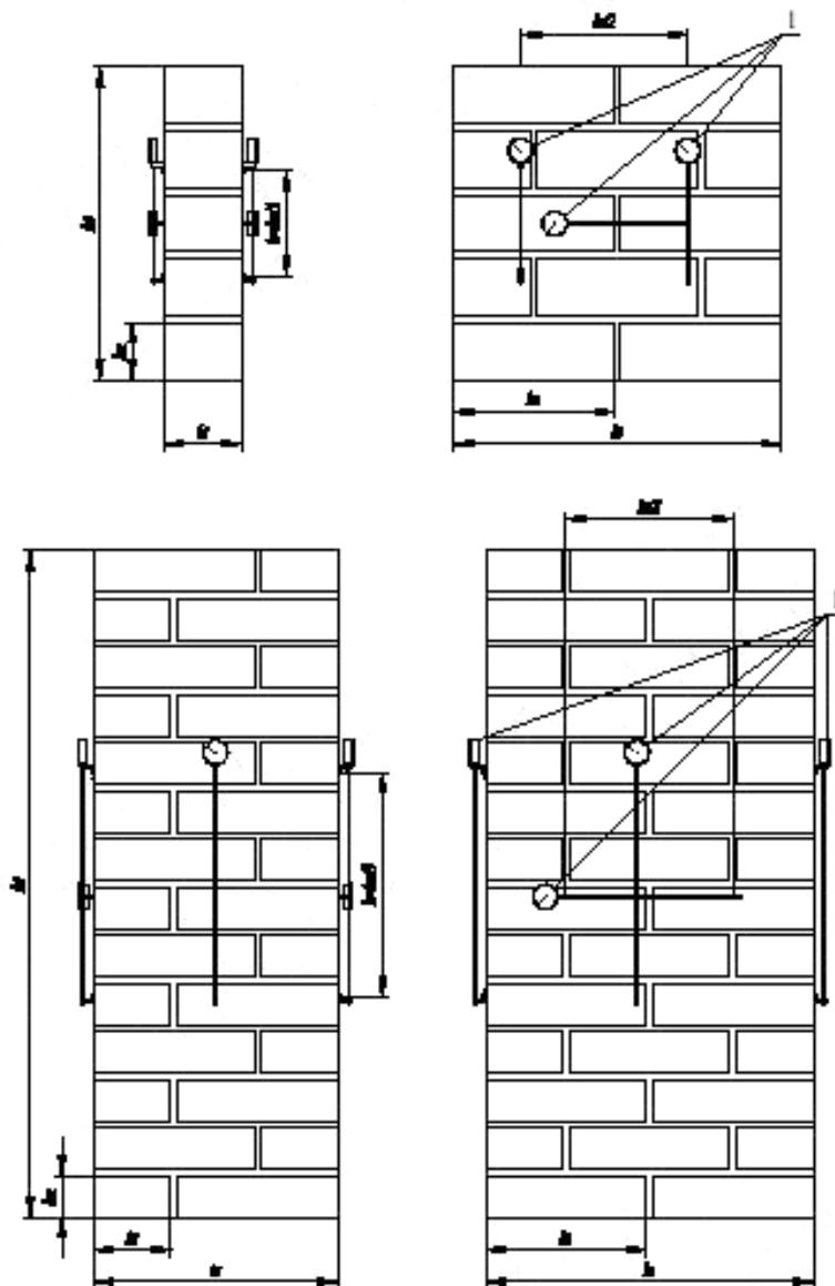
1 – приборы для измерения деформаций;  $b$  – база измерения деформаций;  $h_s$  – высота образца;  $h_v$  – высота элемента кладки;  $t_s$  – толщина образца;  $t_v$  – толщина элемента кладки;  $L_s$  – длина образца;  $L_v$  – длина элемента кладки
