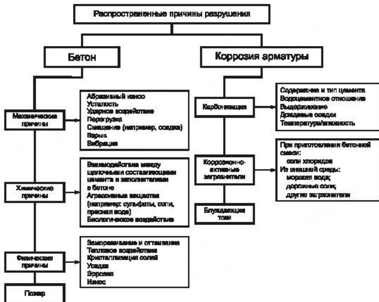
Рисунок 1 — Распространенные причины разрушений конструкций
