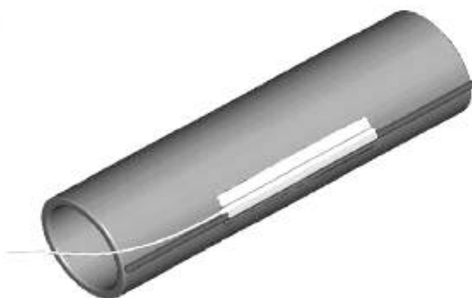
Рисунок 6 — Датчик ограничителя температуры на оболочке электронагревателя
