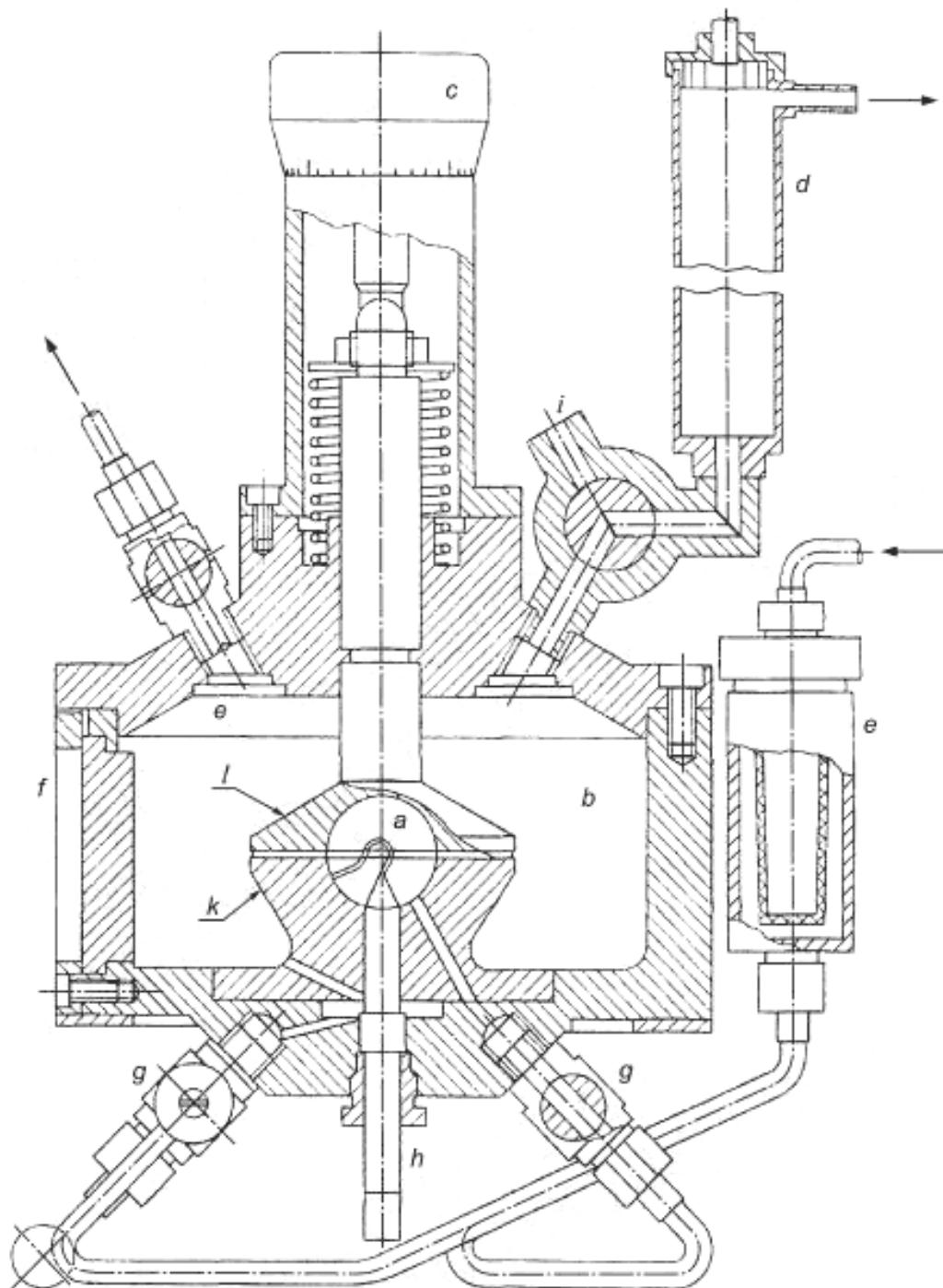
а — внутренняя камера; б — внешняя цилиндрическая оболочка; в — микрометрический винт; г — выходное отверстие; д — огнепреградители; е — смотровые окна; ж — входные вентили; и — искровой электрод; к — нижняя регулируемая поверхность зазора; л — верхняя регулируемая поверхность зазора
