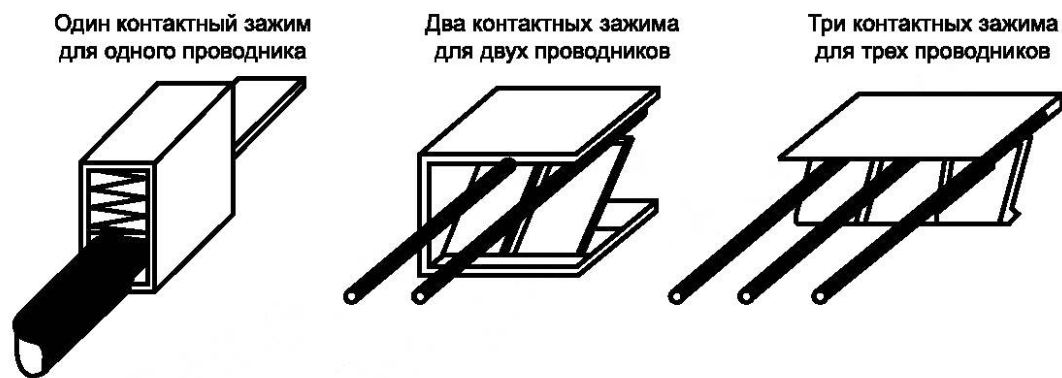
Рисунок F.6 — Примеры безвинтовых контактных зажимов
