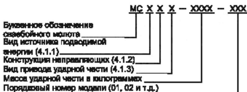
Пример условного обозначения сваебойного молота гидравлического штангового двойного действия с массой ударной части 2500 кг, третьей модели:
