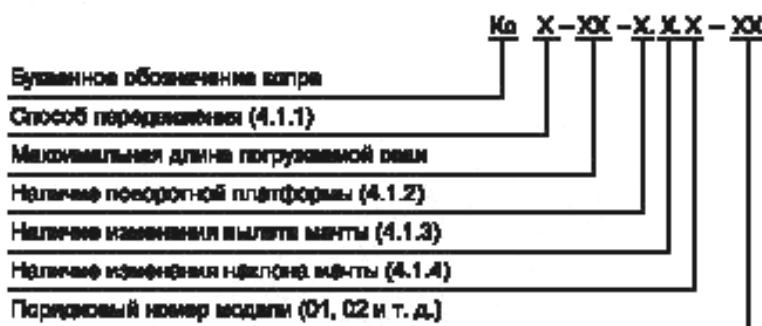
Пример условного обозначения копра на гусеничном ходу для забивки свай длиной до 14 м, с поворотной платформой, без изменения вылета и наклона мачты, второй модели:
