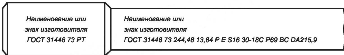
Маркировка краской муфты и трубы (на расстоянии не менее чем 0,6 м от торца муфты)
