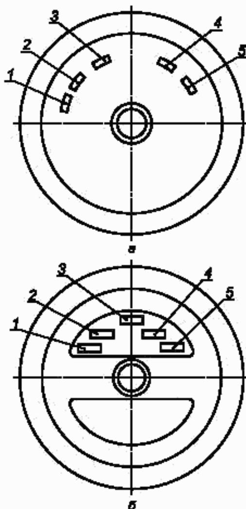
1 — условный номер предприятия — изготовителя черновой оси; 2 — месяц и две последние цифры года изготовления черновой оси; 3 — номер оси; 4 — клейма технического контроля предприятия-изготовителя и представителя заказчика, принявших чистовую ось; 5 — условный номер предприятия-изготовителя, обработавшего черновую ось
