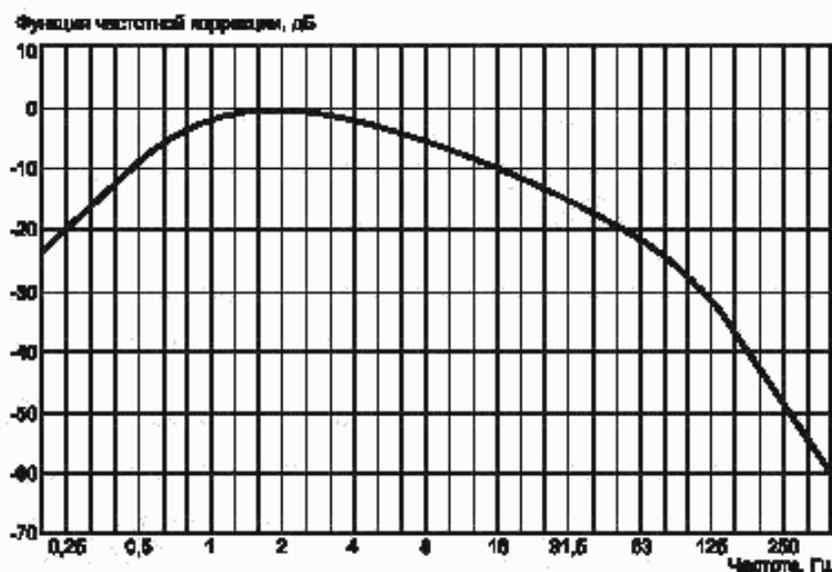
Рисунок А.1 — Функция частотной коррекции  $W_m$  для сигнала ускоренияТ а б л и ц а А.1 — Значения функции частотной коррекции  $W_m$  для сигнала ускорения
