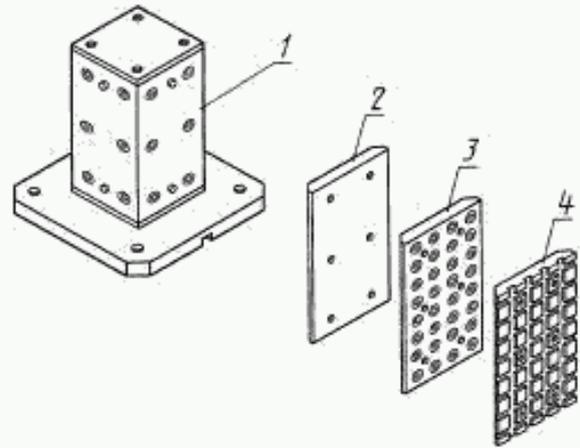
1 — четырёхсторонняя стойка; 2 — основание (плита) неразборного специального приспособления; 3 — основание (плита) универсально-сборного перенастраиваемого приспособления по ГОСТ 31.121.41; 4 — основание (плита) универсально-сборного приспособления по ГОСТ 31.111.41
