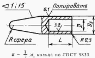
Диаметр оправки  $D$  устанавливается в зависимости от диаметра штока или поршня, а  $L$  — от расположения гнезд в соединении, в которые будет монтироваться уплотнительное кольцо.
