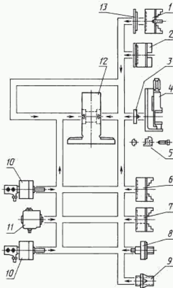
1 — патрон с жесткими кулачками; 2 — патрон с мягкими кулачками; 3 — установочный переходный фланец; 4 — тиски наладочные; 5 — крепежный набор; 6 — вращающийся патрон; 7 — невращающийся патрон; 8 — разжимная оправка; 9 — переходная втулка для закрепления оснастки с базированием на конический хвостовик; 10 — вращающийся привод; 11 — невращающийся привод; 12 — двухсторонняя стойка; 13 — переходный фланец по ГОСТ 3889
