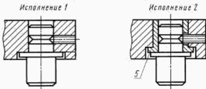
1 — установочный винт; 2 — установочный палец, сменный цилиндрический или срезанный (конструкция и размеры: а) для пальцев с упором — по ГОСТ 16898; б) для пальцев срезанных с упором — по ГОСТ 16899; в) для пальцев установочных цилиндрических сменных — по ГОСТ 12211; г) для пальцев установочных срезанных сменных — по ГОСТ 12212); 3 — шайба резьбовая — по ГОСТ 12219; 4 — втулка — по ГОСТ 12215; 5 — втулка с буртиком — по ГОСТ 12214
