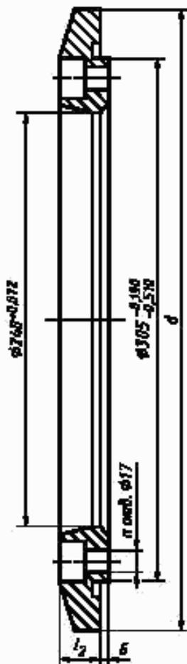
Рисунок 4 — Подвижный фланец с посадочным диаметром 305 мм
