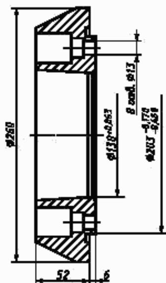
Рисунок 5 — Подвижный фланец с посадочным диаметром 203 мм
