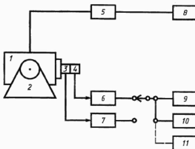
1 — вибростенд; 2 — опора вибростенда; 3 — эталонный датчик; 4 — калибруемый датчик; 5 — усилитель мощности; 6 — согласующий усилитель калибруемого датчика; 7 — согласующий усилитель эталонного датчика; 8 — низкочастотный генератор сигналов; 9 — электронный вольтметр; 10 — измеритель нелинейных искажений; 11 — электронный осциллограф
