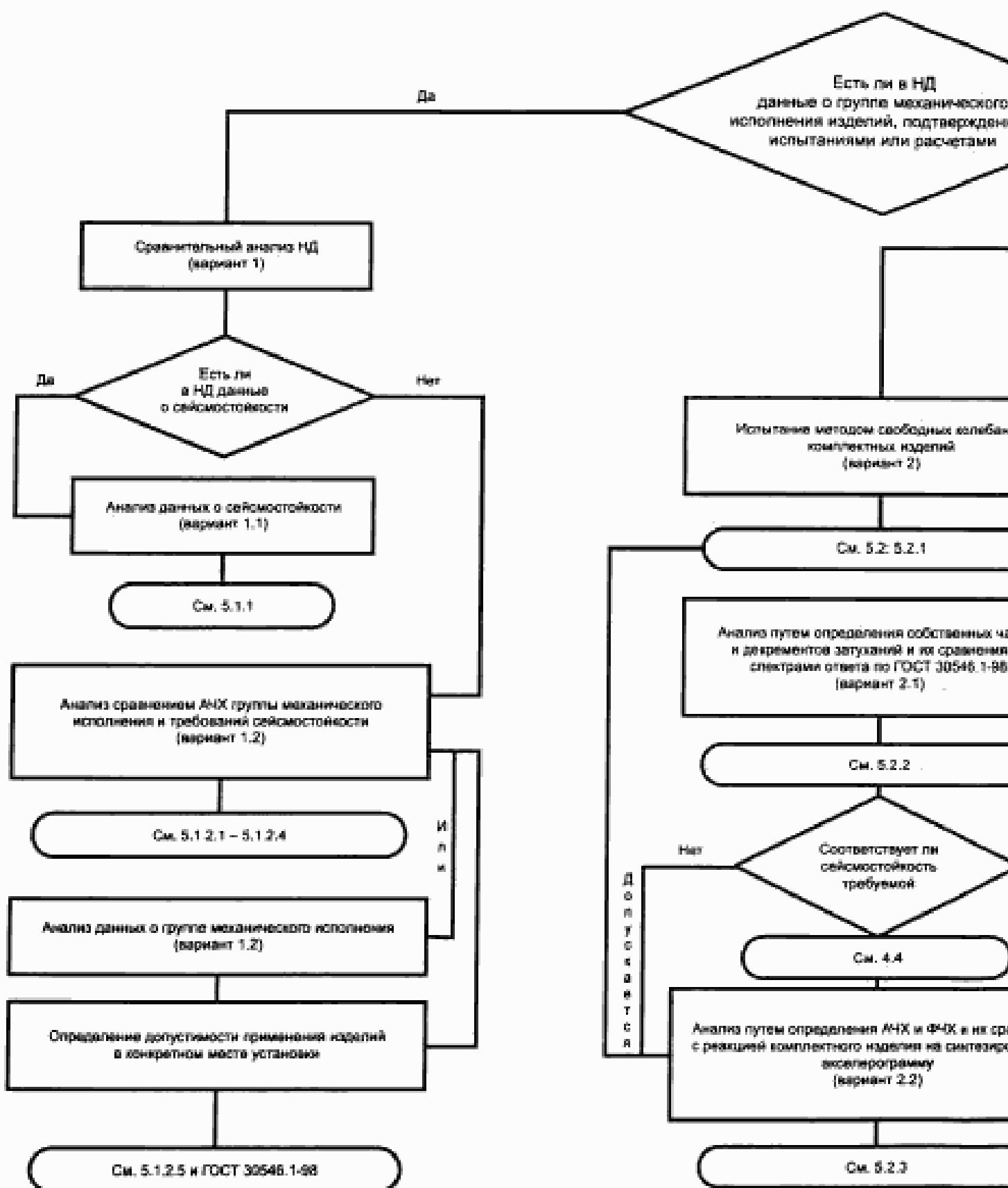
**СХЕМА АНАЛИЗА ТЕХНИЧЕСКИХ ДАННЫХ И ПОСЛЕДУЮЩЕГО УСТАНАВЛИВАЕМЫХ НА ПРОМЕЖУТОЧНЫЕ КОНСТРУКЦИИ**
