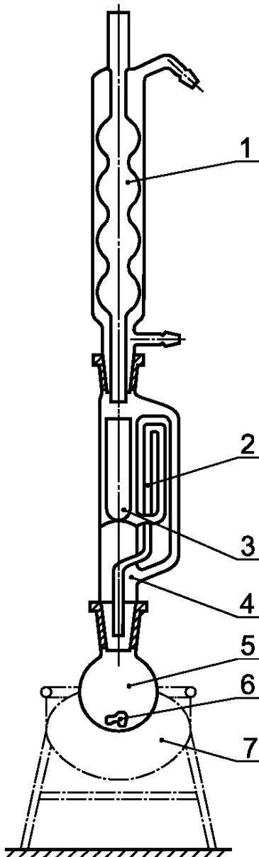
1 — холодильник шариковый; 2 — сифон; 3 — элемент фильтрующий; 4 — экстрактор Сокслета; 5 — колба круглодонная; 6 — кусочки пемзы; 7 — устройство нагрева колбы
