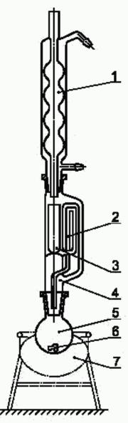
І — холодильник шариковый; 2 — сифон; 3 — элемент фильтрующий; 4 — экстрактор Соксаета; 5 — колба круглодонная; 6 — кусочки пемзы; 7 — устройство нагрева колбы
