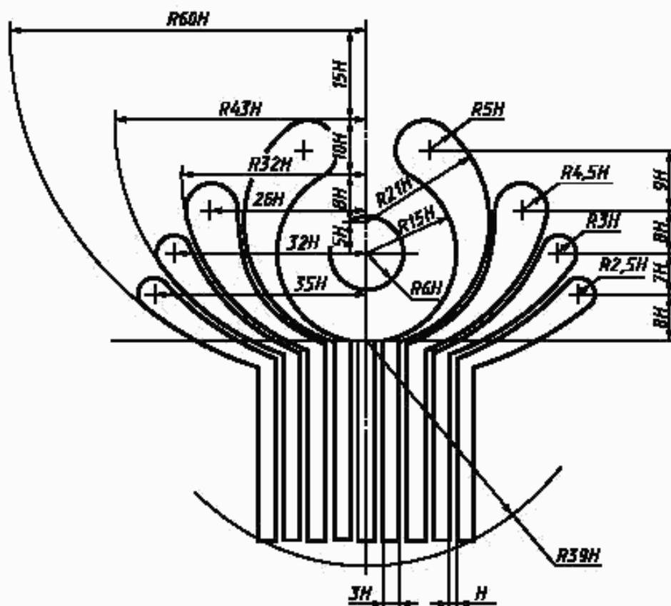
$H$  — размер провета, принимаемый за основу при построении
