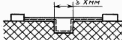
Условие: рассматриваемый путь включает паз с параллельными боковыми стенками любой глубины и шириной, равной  $X$  мм или больше.
