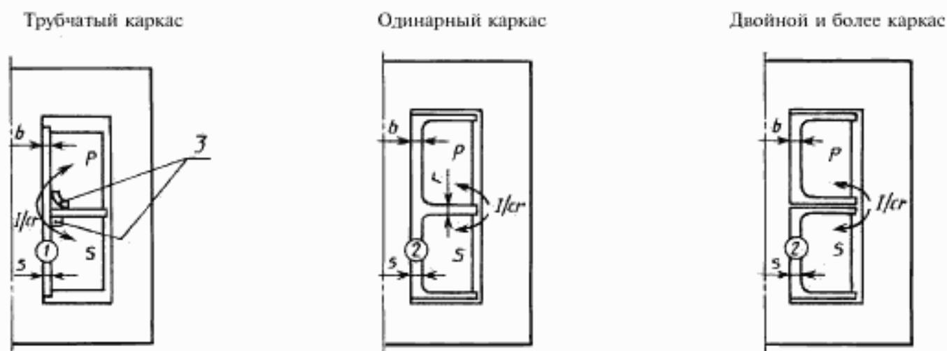
1 — трубка толщиной, указанной для дополнительной изоляции, или не менее трех слоев ленты (см. раздел 25); 2 — формованная часть толщиной, указанной для дополнительной изоляции (см. раздел 25); 3 — изоляционная вставка (прокладка); 4 — дистанционная прокладка (например четыре прокладки)
