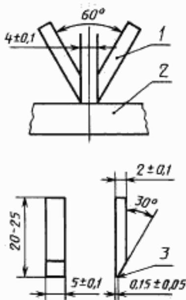
1 — электрод; 2 — образец; 3 — слейка закруленный край
