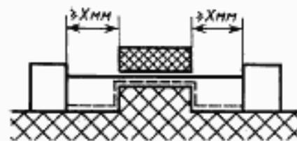
Условие: рассматриваемый путь включает несклеенное соединение с пазами шириной  $X$  мм или более на каждой стороне.
