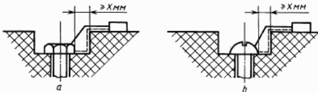
Зазор между головкой винта и стенкой выемки достаточно широк и его следует учитывать.
