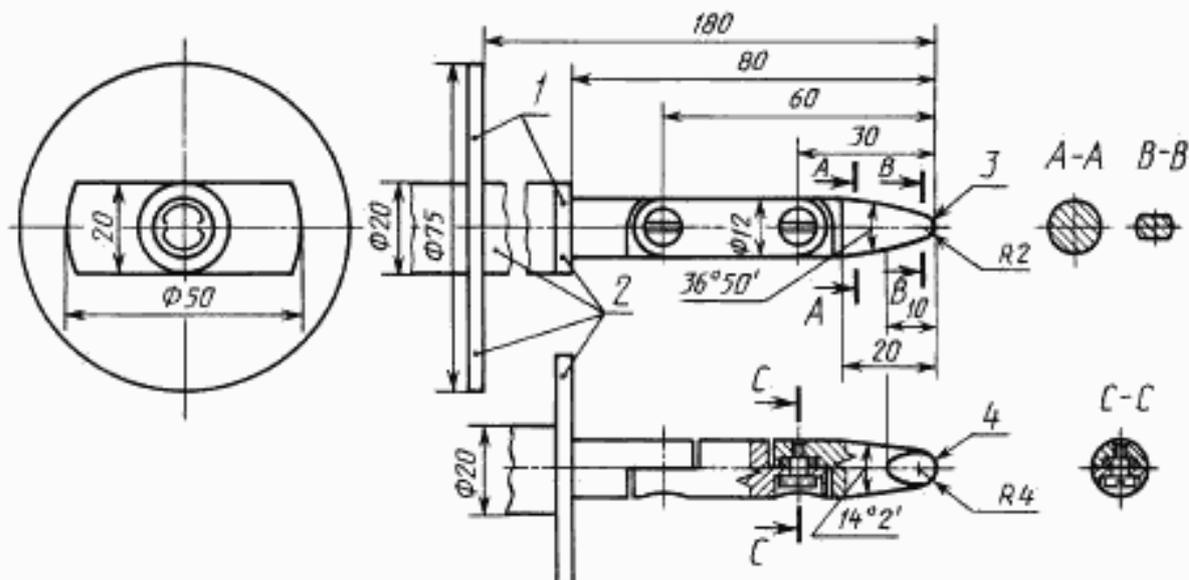
1 — уторная пластина; 2 — изолирующий материал; 3 — цилиндрическая часть; 4 — сферическая часть.
