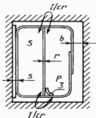
Первичная и вторичная обмотки полностью заключены в корпус (нет зазоров и путей утечки)
