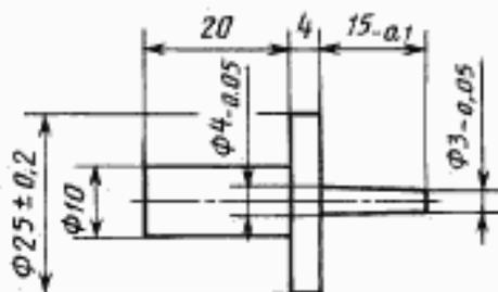
Рисунок 4 — Испытательный стержень
