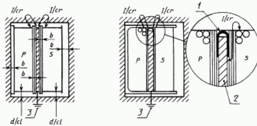
1 — клейкая связующая лента; 2 — экран; 3 — заземление
