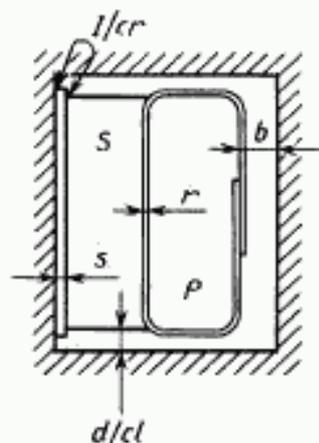
Первичная или вторичная обмотки, обернутые изоляционным материалом (без воздушного зазора)
