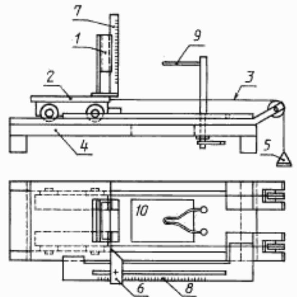
1 — регулирующий зажим положения; 2 — тележка; 3 — натяжной шнур; 4 — опорная плита; 5 — пруж; 6 — регулируемый упор; 7 — масштабная линейка для измерения высоты пламени; 8 — масштабная линейка для измерения глубины проникания проволоки накала; 9 — проволока накала (рисунок 6); 10 — отверстие в опорной плите
