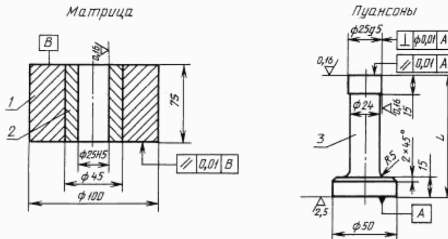
1 — обойма; 2 — металлокерамический твердый сплав; 3 — пуансоны верхний ( $L = H - 10$ ) и нижний ( $L = H + 35$ )
