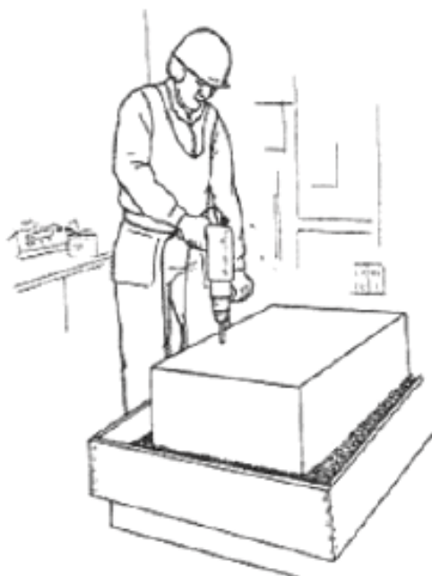
Рисунок 16 – Рабочая поза оператора при испытаниях строительных перфораторов, перфораторов для анкерных работ и легких бурильных молотков
