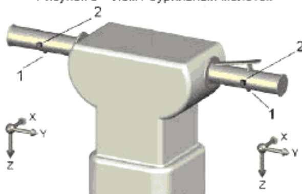
Рисунок 9 – Точки измерений для лома / бурильного молотка с Т-образными антивибрационными «качающимися» рукоятками
