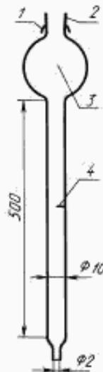
1 — стеклянные крочки; 2 — притертое соединение 10/19; 3 — емкость; 4 — калиброванная отметка на 10 г силикагеля
