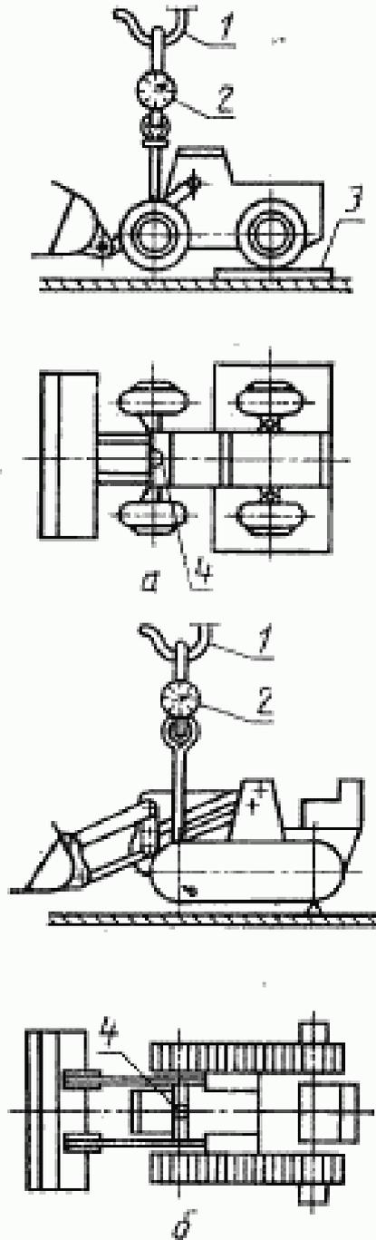
1 — крюк подъемного крана; 2 — динамометр; 3 — подкладная платформа; 4 — стальной канат к динамометру
