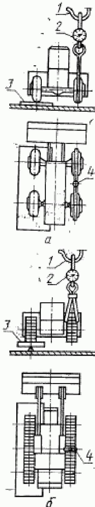
1 — крюк подъемного крана; 2 — динамометр растяжения; 3 — подкладная платформа; 4 — стальной канат к динамометру
