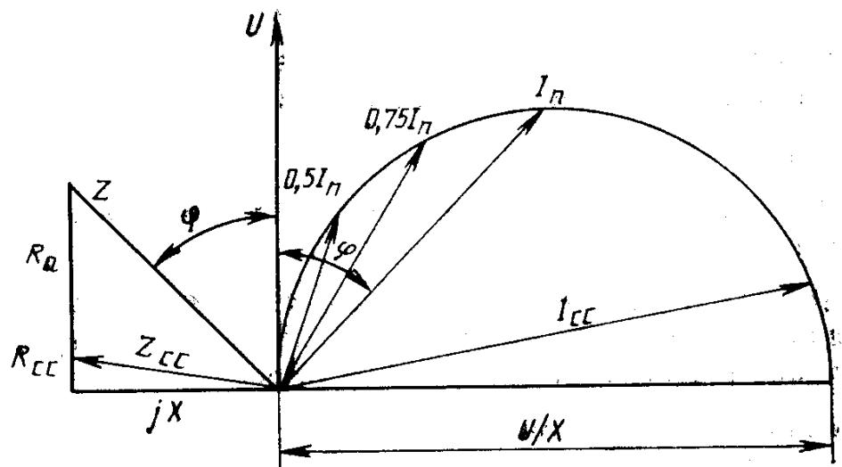
$R_d$  — дуговое сопротивление;  $R_{cc}$  — сопротивление вторичной силовой цепи;  $Z_{cc}$  — полное сопротивление вторичной силовой цепи;  $I_n$  — номинальный ток;  $I_{cc}$  — ток вторичной силовой цепи
