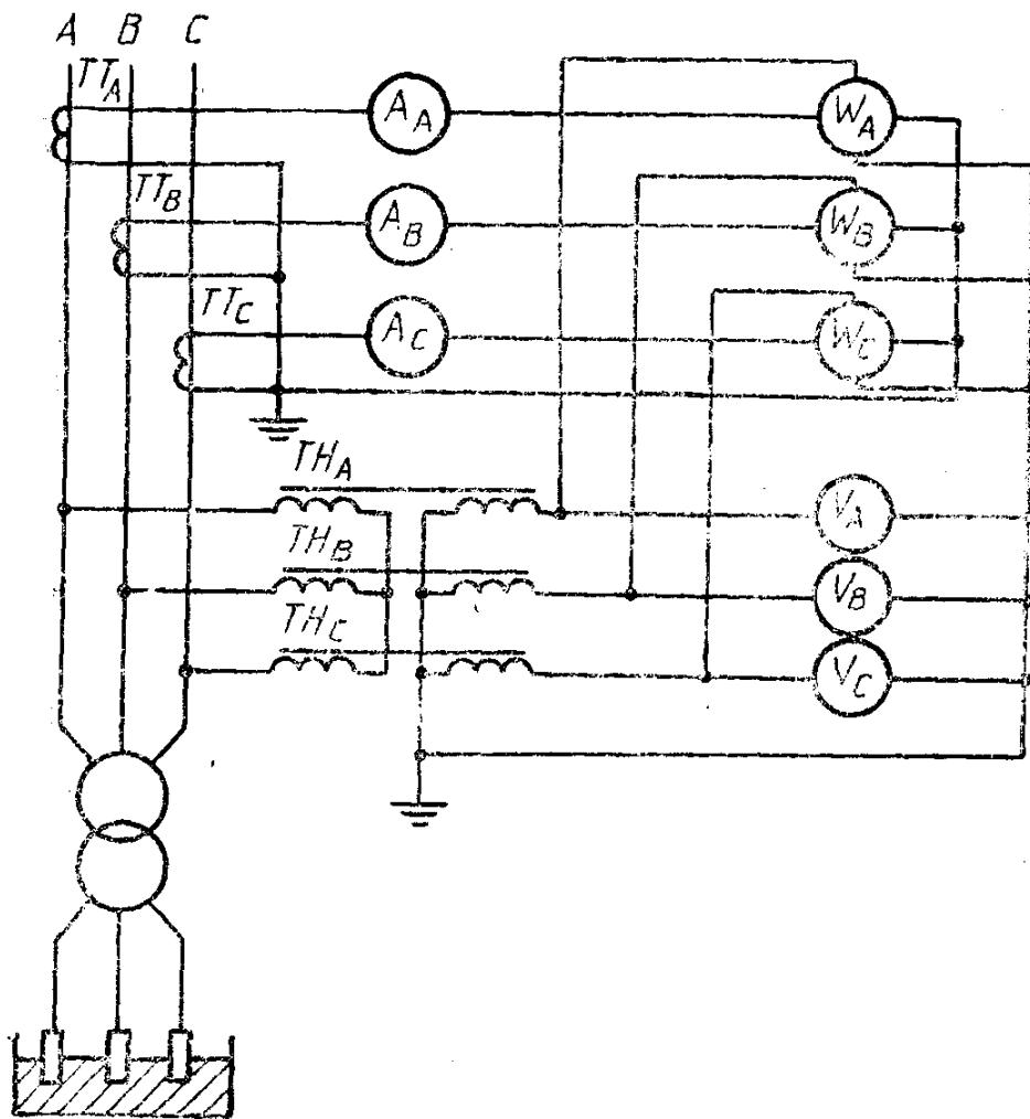
$A, B, C$  — обозначение фаз;  $V_A, V_B, V_C$  — вольтметры или датчики напряжения;  $A_A, A_B, A_C$  — амперметры или датчики тока;  $W_A, W_B, W_C$  — ваттметры или датчики активной мощности.
