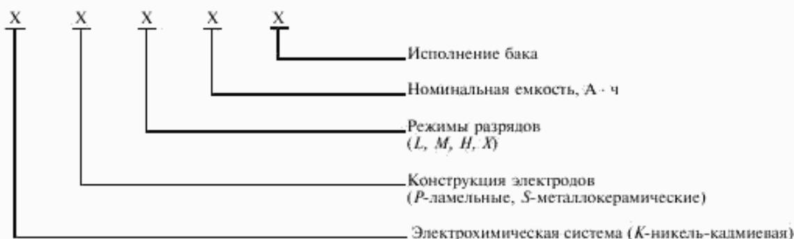
Пример условного обозначения аккумулятора никель-кадмиевой системы с ламельными электродами короткого режима разряда, емкостью 150 А · ч в пластмассовом баке.
