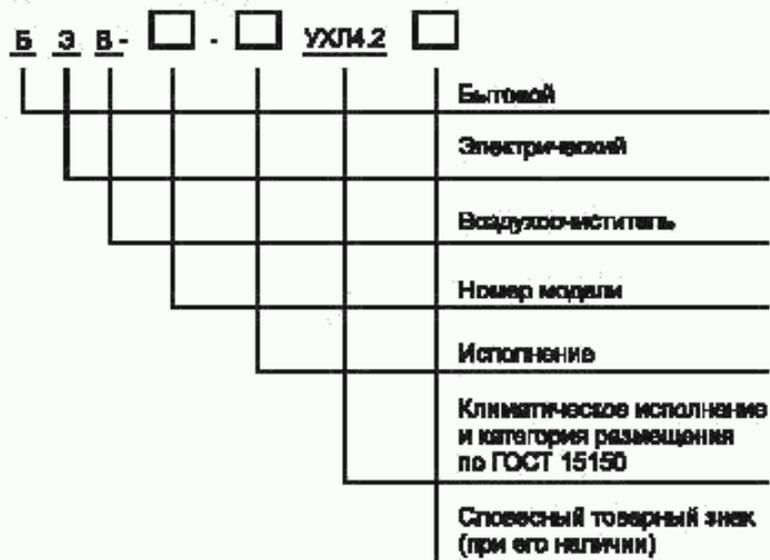
Пример условного обозначения воздухоочистителя с номером модели 3, исполнения I:
