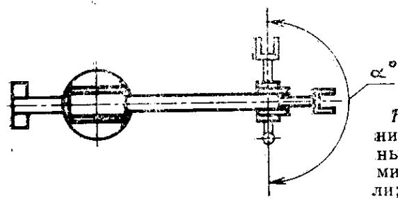
$H$ —максимальная высота обслуживания;  $h_1$ —минимальная высота обслуживания;  $R$ —максимальный радиус обслуживания по горизонтали;  $R_1$ —минимальный радиус обслуживания по горизонтали;  $\alpha^\circ$ —поворот исполнительного органа вокруг вертикальной оси.
