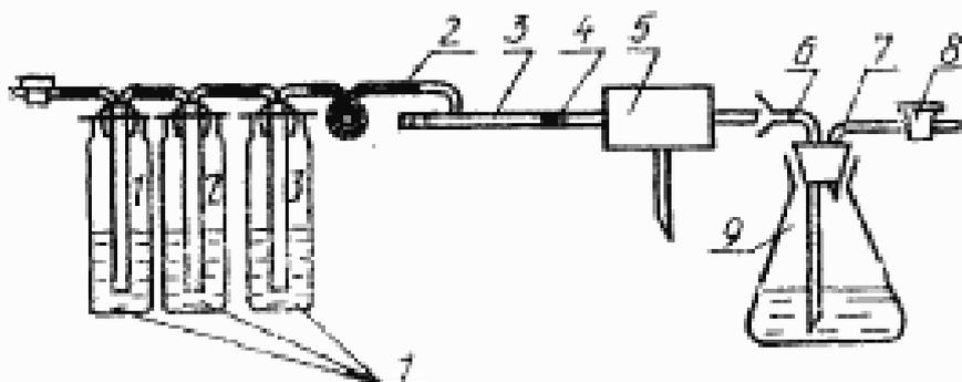
1—слайки Дрейселя; 2—боковой отросток; 3—кварцевая трубка со шлифом (черт. 2); 4—фарфоровая лодочка; 5—электрическая печь; 6—кварцевое колено; 7—отводная трубка к насосу; 8—кран; 9—приемник.
