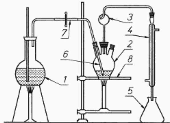
1 — парообразователь; 2 — перегонная колба; 3 — каплеуловитель; 4 — холодильник; 5 — приемная колба; 6 — резиновая трубка с зажимом; 7 — стеклянная трубка диаметром 4 мм; 8 — металлическая подставка
