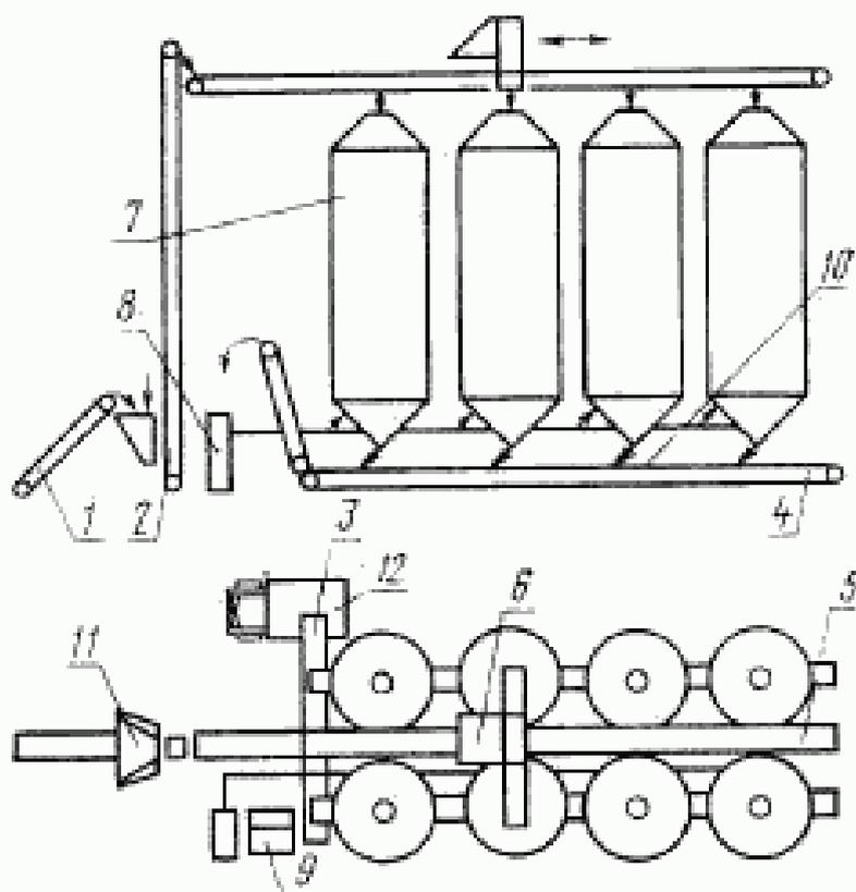
1—5—устройства транспортировки кормов; 6—устройство распределения; 7—бункеры; 8—оборудование создания РГС (РТ); 9—система управления; 10—система развозки РГС (РТ); 11—устройство привода; 12—автотранспорт
