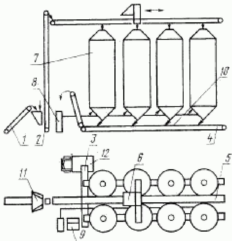
1—5—устройства транспортирования кормов; 6—устройство распределения; 7—бункеры; 8—оборудование для создания РГС (РТ); 9—система управления; 10—система разброски РГС (РТ); 11—устройство приемки; 12—автотранспорт
