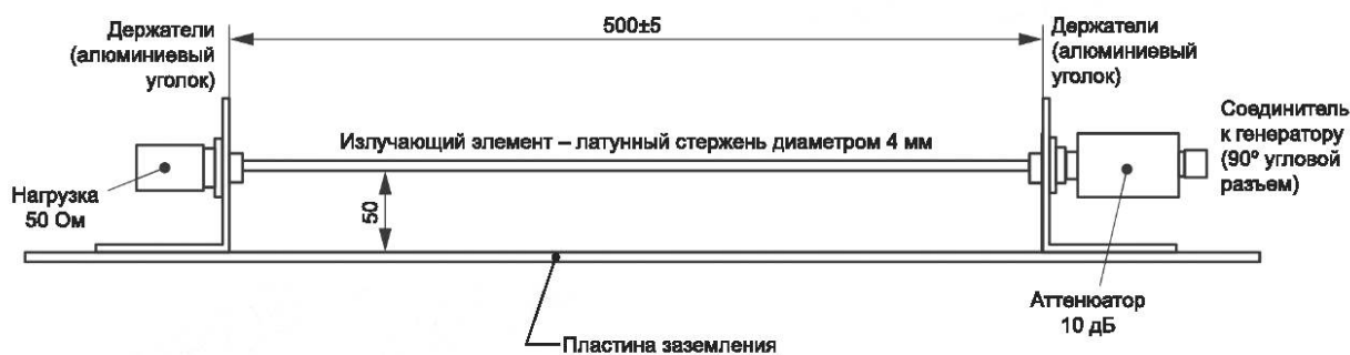
Рисунок I.4 — Излучатель с нагрузкой 50 Ом, вид сбоку
