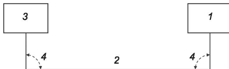
1 — EUT; 2 — испытуемые провода; 3 — имитатор нагрузки; 4 — угол 90^{+45} градусов
