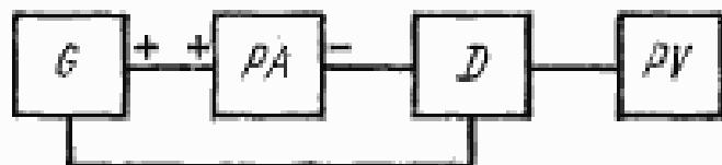
*G*—генератор постоянного тока; *PA*—измеритель постоянного тока; *PV*—измеритель постоянного напряжения; *D*—измеряемый оптоэлектронный коммутатор
