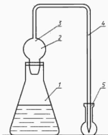
1 — реакционная колба вместимостью 250, 300 см<sup>3</sup>; 2 — вата, пропитанная раствором уксуснокислого свинца; 3 — расширение для ваты; 4 — соединительная трубка со шлифом; 5 — мерная колба вместимостью 25 см<sup>3</sup>.
