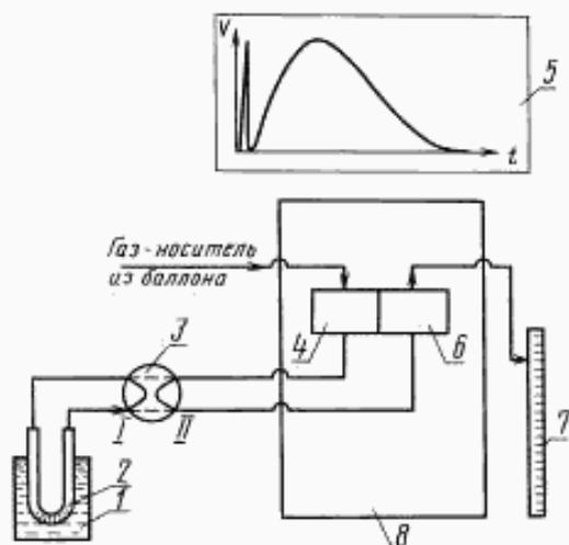
1 — стакан вместимостью 250 см<sup>3</sup>; 2 — U-образная трубка с внешним диаметром 5 мм, высотой 100 мм, расстоянием между концами 35 мм; 3 — четырехходовой кран; 4 — сравнительная ячейка детектора; 5 — самописец; 6 — измерительная ячейка детектора; 7 — измеритель скорости; 8 — термостат.
