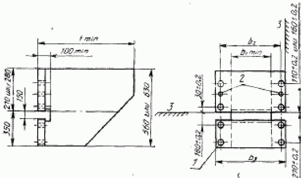
1—восемь отверстий с гарантированным зазором; 2—два отверстия под штифты (при необходимости); 3—базовая линия
