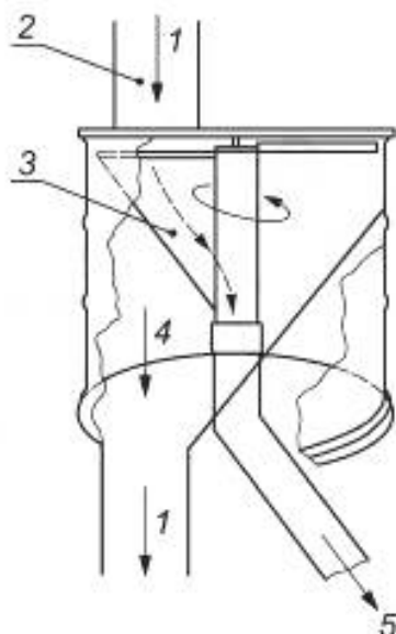
1 — поток зерна, 3 — вращающаяся воронка; 2 — вертикальная труба; 4 — поток зерна; 5 — поток пробы
