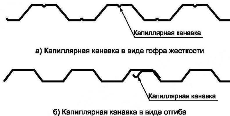
Рисунок 3 — Основные виды капиллярных канавок
