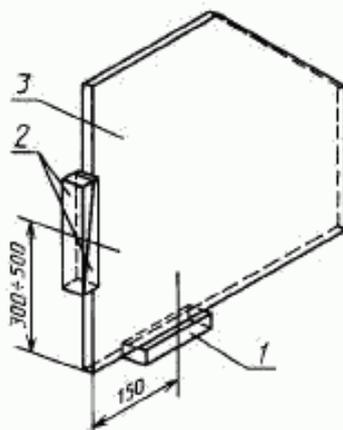
1 — опорная подкладка; 2 — фиксирующая подкладка;
